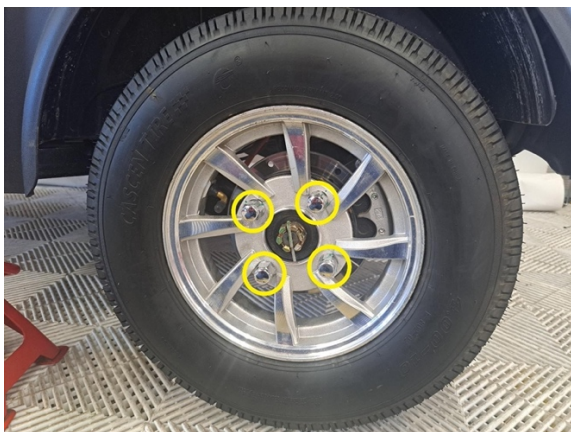
Irrota pyörän kiinnitysmutterit. (hylsy 19 mm).
