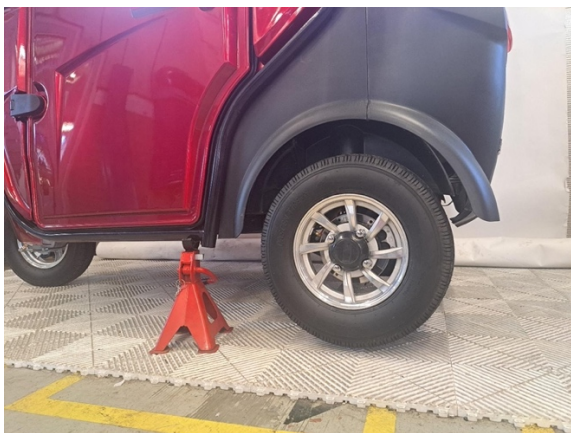
Nosta Autokruiserin vaihdettavan osan puoleinen takaosa ylös. (tunkki).
